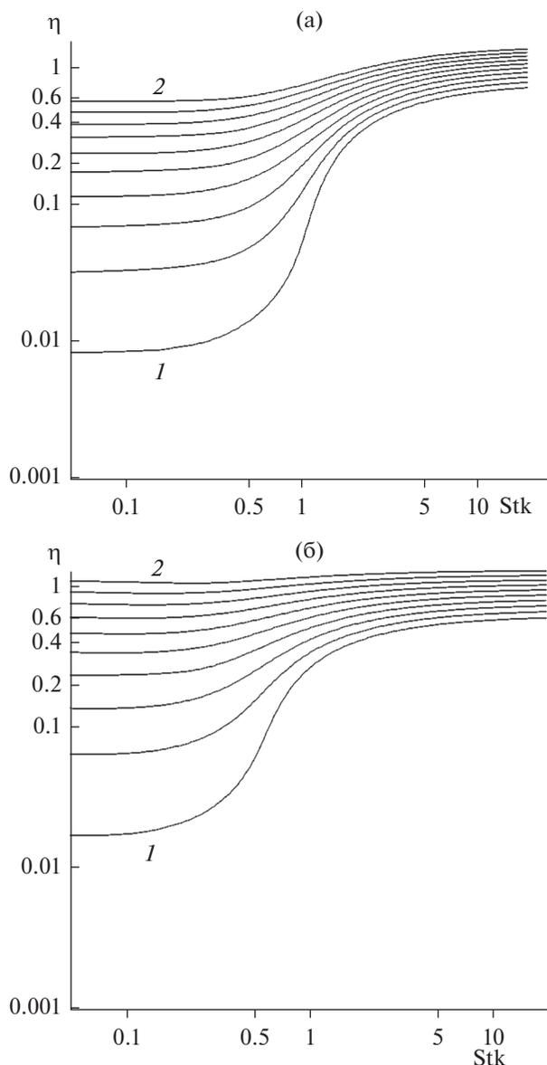
**Рис. 6.** Зависимости коэффициента захвата частиц за счет инерции и зацепления от  $Stk$  для волокна в ячейке Кувабары с плотностью упаковки  $\alpha = 1/36$  (а),  $1/9$  (б) для параметров зацепления в диапазоне от  $R = 0.1$  (1) до 1 (2) с интервалом 0.1;  $Kn = 0$ .
