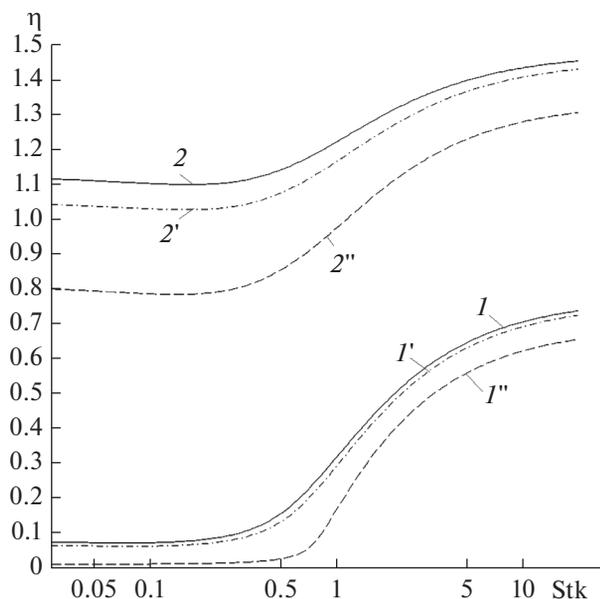
**Рис. 10.** Зависимости коэффициентов захвата частиц волокном за счет инерции и зацепления для частиц конечного размера при  $R = 0.1$  ( $I, I', I''$ ) и  $R = 1$  ( $2, 2', 2''$ ) от  $Stk$  с учетом эффекта скольжения газа при  $Kn = 1$  ( $I, I', 2, 2'$ ) и  $Kn = 0$  ( $I'', 2''$ ):  $I, 2$  — расчет для поля скоростей (16) (кинетическая теория, [15]),  $I', 2'$  — (15) (течение со скольжением, [14]),  $I'', 2''$  — поля скоростей [20]; ячеечная модель Кувабары,  $\alpha = 1/16$ .
