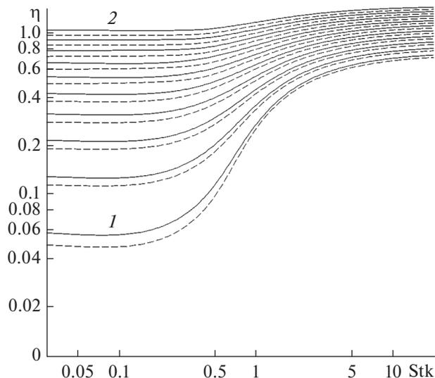
**Рис. 9.** Зависимости коэффициентов захвата за счет инерции и зацепления от  $Stk$ : сплошные линии – с учетом поля скоростей (15), (16) [15], пунктирные – (11), (13) [14], для параметров зацепления в диапазоне  $R = 0.1$  (1) до  $R = 1$  (2) с интервалом 0.1; ячеечная модель,  $\alpha = 1/16$ ,  $Kn = 0.3$ .
