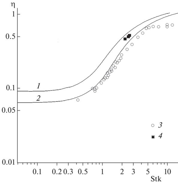
**Рис. 2.** Зависимости коэффициента захвата частиц волокном в ряду волокон от числа Стокса  $Stk$  для  $R = 0.38$  (1),  $0.3$  (2),  $t = 0.233$ . Сравнение с экспериментом (рис. 2 в [16]):  $r_p = 1.37$  (3),  $1.7$  (4),  $2a = 8.9$ ,  $2h = 62.7$  мкм.
