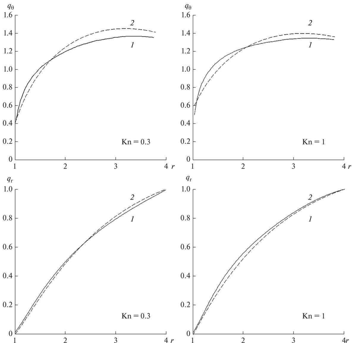
Рис. 7. Зависимости  $u_\theta/\sin\theta$  и  $-u_r/\cos\theta$  от радиальной координаты в ячейке с ультратонким волокном для разных  $Kn$ : 1 – по (16) (кинетическая теория [15]), 2 – по (11) (течение со скольжением [14]),  $\alpha = 1/16$ .
