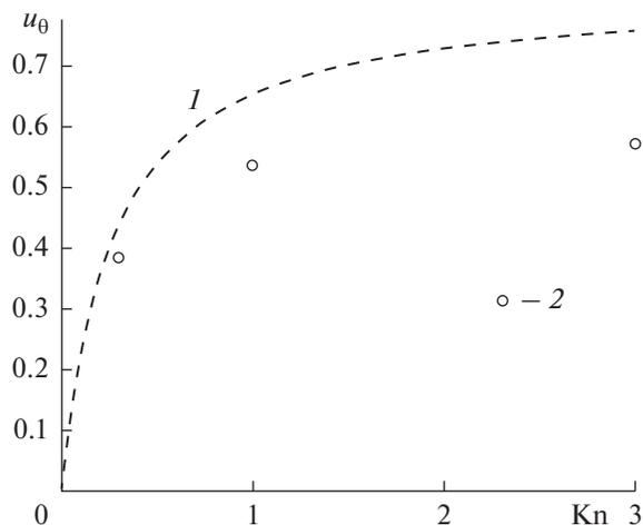
**Рис. 8.** Сравнение тангенциальных скоростей потока (скоростей скольжения на поверхности волокна) при  $\theta = \pi/2$  и  $r = 1$  от  $Kn$ , 1 – по (11) (течение со скольжением,  $Kn \leq 1$ ) [14], точки 2 – по (16) (численно-аналитическое решение [15], промежуточные и большие  $Kn$ ),  $\alpha = 1/16$ .
