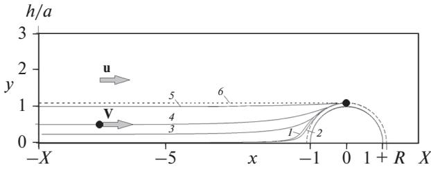
**Рис. 1.** Граничные траектории инерционных частиц при осаждении из стока поперечного потока на волокно в ряду волокон:  $Stk = 0.01$  (1),  $0.1$  (2),  $5$  (3),  $10$  (4),  $100$  (5),  $Stk \rightarrow \infty$ , безинерционная частица (6);  $b = a/h = 1/3$ ,  $R = 0.1$ ; расчет по (2), (3).
