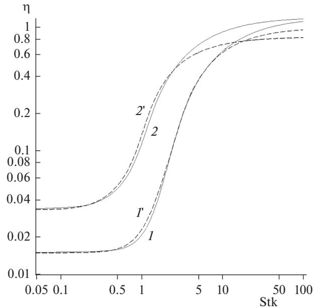
**Рис. 5.** Зависимости коэффициента захвата частиц с  $R = 0.2$  за счет инерции от  $Stk$  в ряду параллельных волокон (1–2) и в ячеечной модели с той же плотностью упаковки  $\alpha = \pi b^2/4$  (1'–2'): параметр ряда  $b = 0.05$  (1, 1'),  $0.1$  (2, 2').
