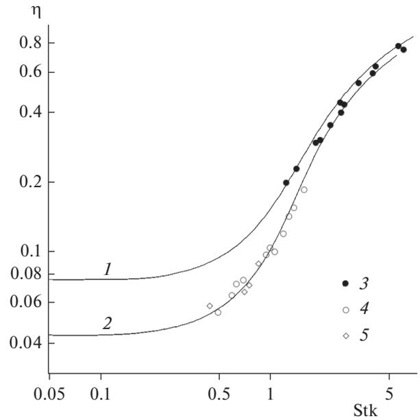
**Рис. 3.** Зависимости коэффициента захвата частиц за счет инерции и зацепления волокном в ряду от  $Stk$  для  $R = 0.34$ ,  $r_p = 1.5$  мкм (1) и  $r_p = 1.1$  мкм,  $R = 0.26$  (2),  $t = \pi b/2 = 0.233$ ,  $2a = 8.9$  мкм,  $2h = 62.7$  мкм. Сравнение с экспериментом (рис. 3 в [16]):  $r_p = 1.5$  (3),  $1.18$  (4),  $1.1$  мкм (5).
