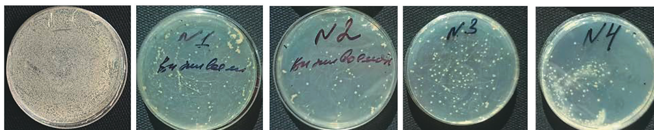
Рис. 5. Изображения образцов с бактериями Staphylococcus aureus после антибактериального теста. Слева показан контрольный образец – матрица без покрытия. 1 – SDND, 2 – SDND–лизоцим–мирамистин, 3 – DND, 4 – DND–лизоцим–мирамистин.
