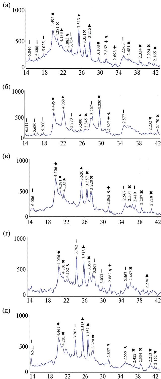
**Рис. 1.** Рентгеновские порошковые дифрактограммы: а) нативной (НГ), б) ОГ250, в) ОГ350, г) ОГ500, д) ОГ600. ▲ – калиевые полевые шпаты, ● – пиррофиллит, ◆ – палыгорскит, | – монтмориллонит, × – кварц, ▼ – каолинит, ★ – арагонит, ▲ – галлуазит.
