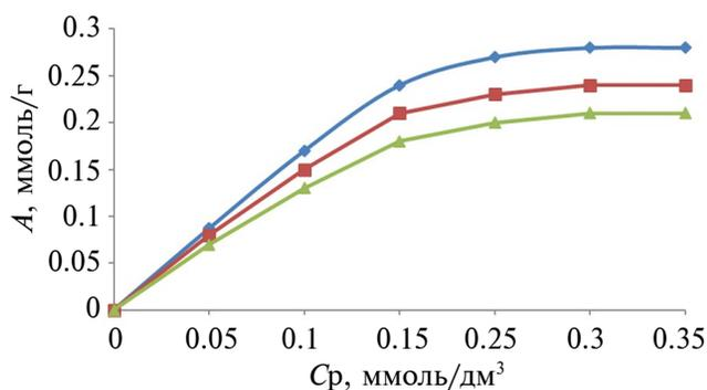
Рис. 5. Изотермы адсорбции МГ ОГ350, ОГ250 и ОГ500.
