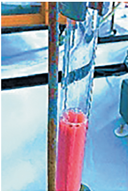
Рис. 3. Фотоснимок водного раствора ММА после 24 ч полимеризации при температуре 60°С.
