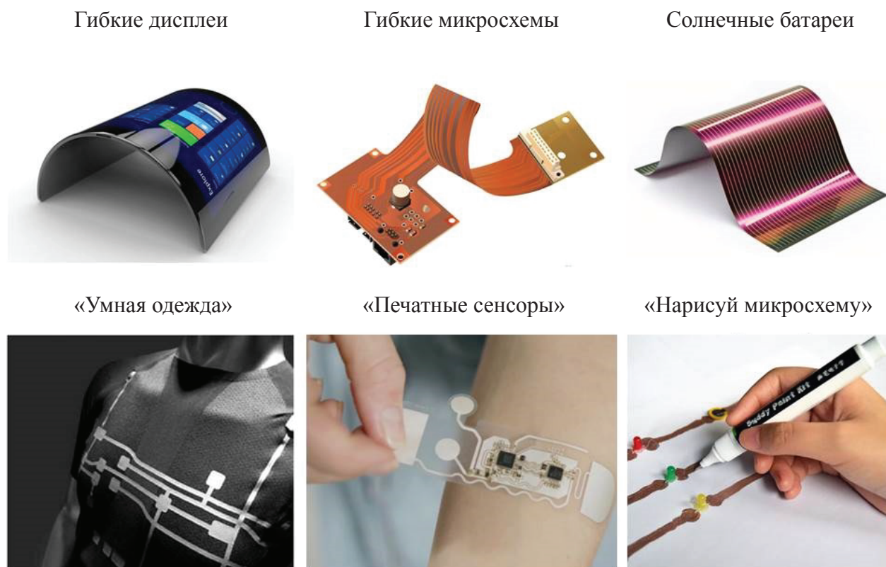
Рис. 1. Примеры использования технологий печатной электроники для создания материалов и устройств. Fig. 1. Examples of using printed electronics technologies to create materials and devices.
