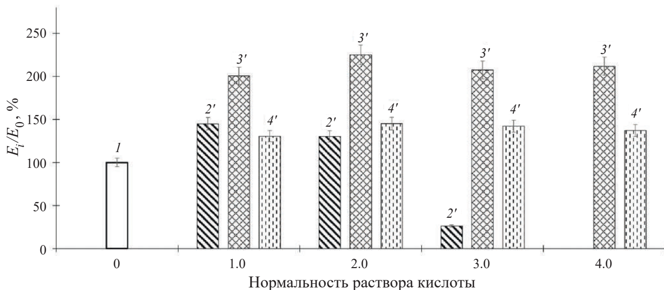
Рис. 5. Относительные изменения значений модуля Юнга ( E ) цилиндрических КГПВС: образцы до кислотной обработки (1), криогели после промывки чистой водой образцов, которые перед промывкой инкубировались в водных растворах HCl (2'), H 2 SO 4 (3') и H 3 PO 4 (4')
